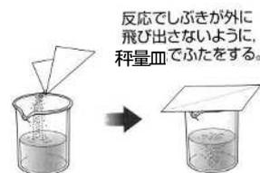
④ ②のコニカルビーカーに、①ではかりとった炭酸カルシウムを少しずつ加えて反応させる。
