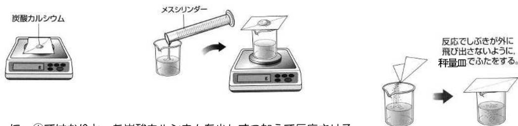
④ ②のコニカルビーカーに、①ではかりとった炭酸カルシウムを少しずつ加えて反応させる。
